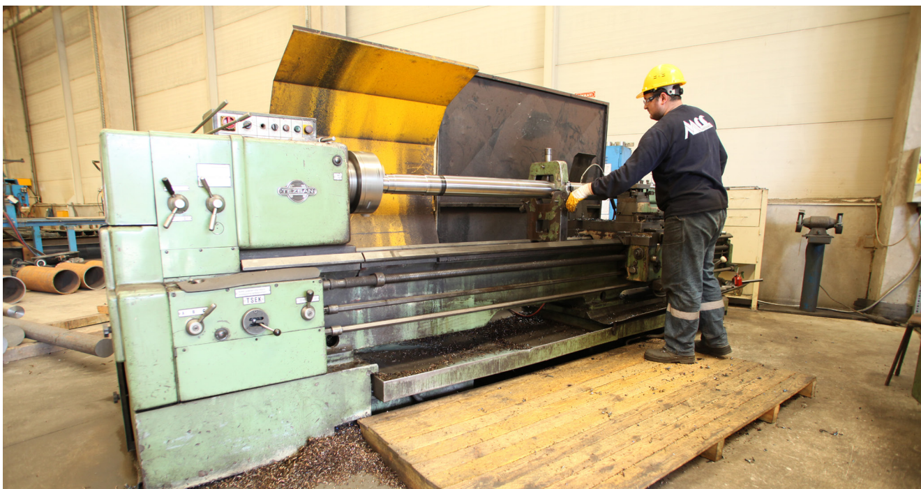
UNIVERSALE DREHBANK SN70 Komponentenlänge: 3000 mm Komponentendurchmesser: 500 mm
