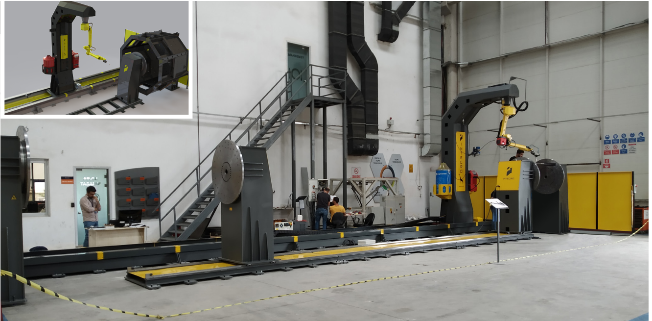
FANUC 100 IC / 8L INDUSTRIEROBOTER Maximaler Schweißdurchmesser: Ø3400 mm Maximale Schweißlänge: 12.000 mm Maximales Schweißgewicht: 6000 kg
