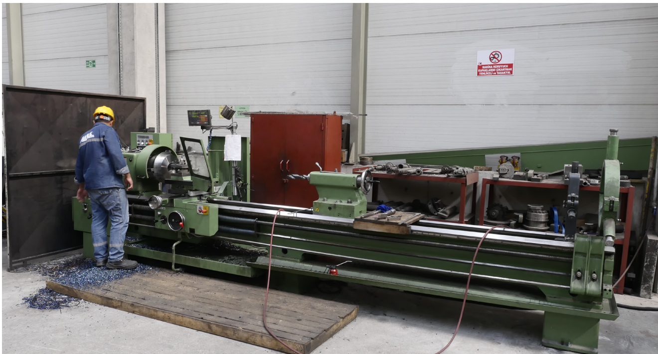
UNIVERSALE DREHBANK SN70 Komponentenlänge: 4000 mm Komponentendurchmesser: 500 mm
